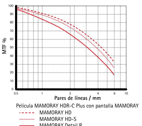
Esta curva es el resultado de las mediciones que proporcionan un nivel de "nitidez intrínseca" del sistema de película / pantalla. Es una medición parcial de la calidad de imagen total del sistema de película / pantalla según se percibe en el negatoscopio. La calidad de imagen total depende de otros factores, además de la "nitidez intrínseca". Los principales factores son: granulación, ruido, contraste de la película y factores estéticos, como la densidad de la película, tono de imagen, etc.
