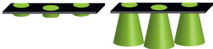
Fase 1 – Reticulación superficial con UV de alta intensidad
