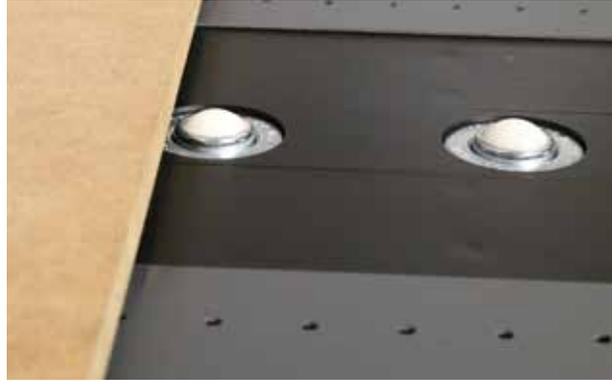
Las **cintas de vacío** del ABF de la Jeti Tauro H2500 LED están siempre correctamente alineadas. Así, la alimentación de los materiales en el motor se lleva a cabo de forma fluida. Varios rollos de liberación ubicados en la parte posterior de la mesa colaboran en este proceso de alimentación. Mientras se imprime un panel, las cintas frontales de vacío se apagan para poder cargar el siguiente panel.
